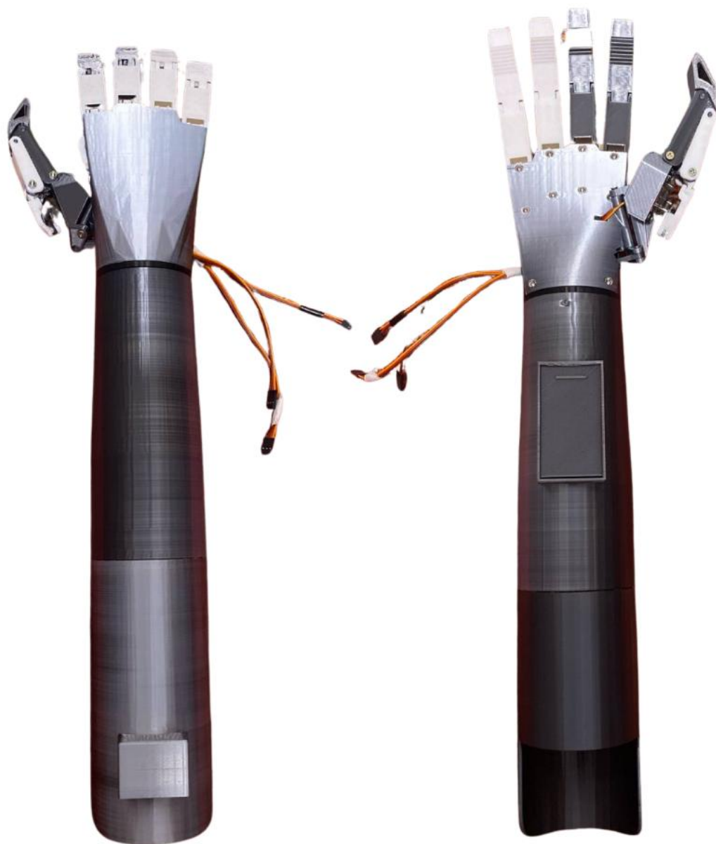
Рисунок 58 – Реализация второй модификации бионического протеза Сборочный чертеж на вторую модификацию приведен в приложении М.
